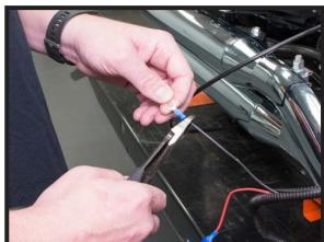
7. TRIM THE BLACK PUMP WIRE EXTENSION TO LENGTH. CRIMP A RING TERMINAL TO THE END AND GROUND TO THE LOCATION SHOWN BELOW. (FIGURES 13, 14)
