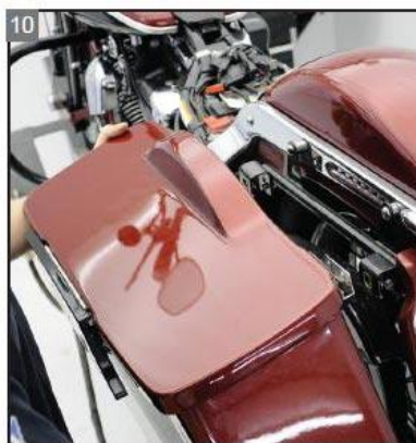
10 Remove the left-side saddlebag.
