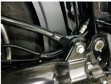
Fig. 3.10 remove plastic grommet
