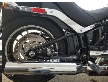
Fig. 3.4 remove upper muffler
