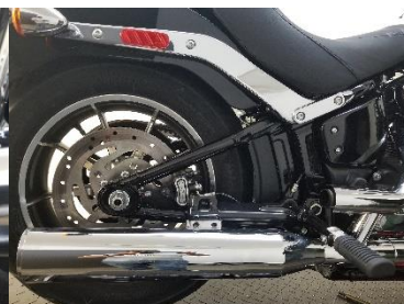
Fig. 3.4 remove upper muffler
