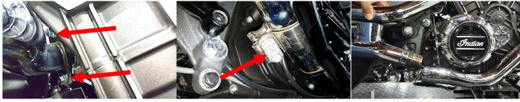
Fig. 1.19 remove flange nuts
