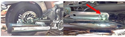
Fig. 1.4 remove top muffler
