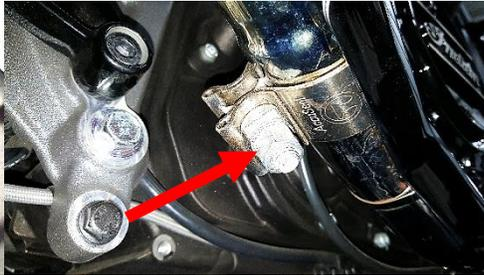
**Fig. 1.20 loosen clamp**
