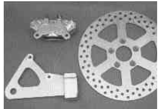
FX BRAKE SYSTEM: PN 1268-0059 11.5" X .275" ROTOR: PN 0131-1518
